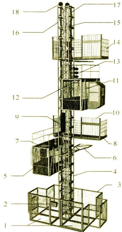
原方向运行，但可以反方向运行。限位开关是防止吊笼冲顶的重要安全保护装置之一。
